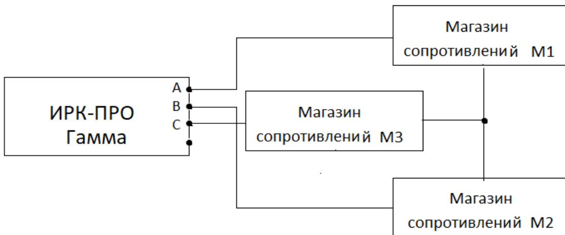
Рисунок 2 – Схема соединения приборов при определении абсолютной погрешности определения расстояния до места повреждения изоляции кабеля
