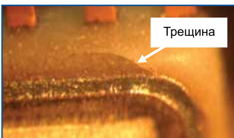
Рис. 3. Образование микротрещины в стеклоизоляторе под ободком корпуса
