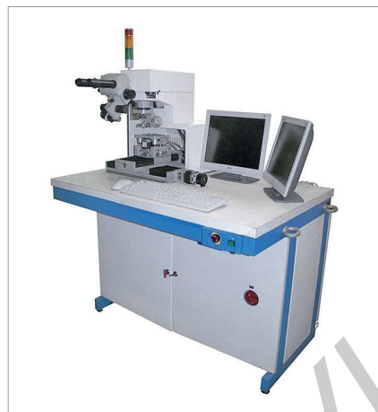
Рис. 5. Автомат присоединения выводов СБИС ультразвуковой сваркой ЭМ-4370
