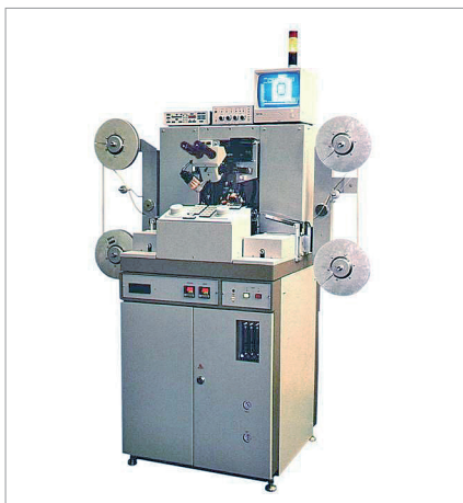
Рис. 4. Автомат прецизионного присоединения проволочных выводов ЭМ-4260
