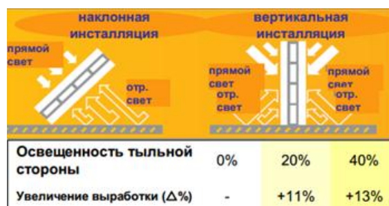
Рис. 1. Варианты инсталляции двухсторонних модулей Sanyo и увеличение годовой выработки электроэнергии при различной освещенности тыльной стороны
