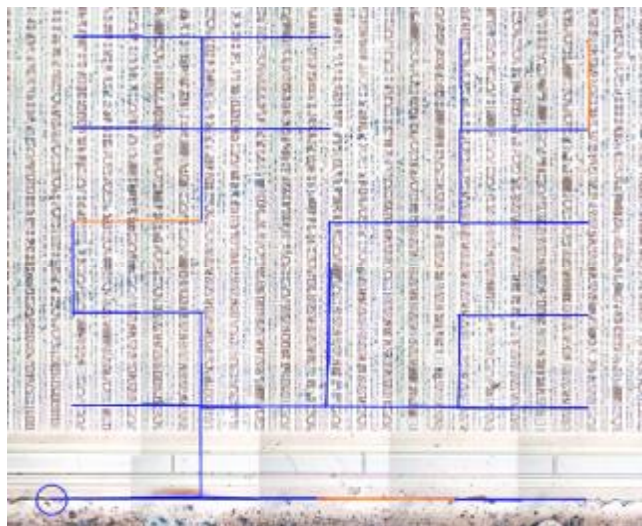
Рис. 3. Результат коррекции расположения кадров и полный маршрут сшивки, оранжевым отмечены пути с дополнительной обратной корректировкой
