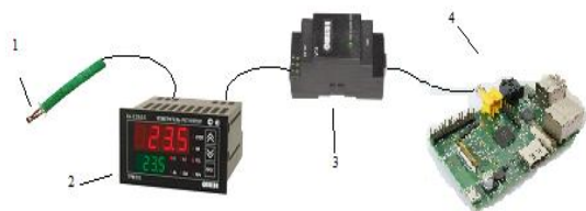
Рисунок 2 – Структурная схема измерения температуры: 1 – датчик температуры (термопара), 2 – измеритель-регулятор TRM210, 3 – автоматический преобразователь интерфейса AC4, 4 – миникомпьютер
