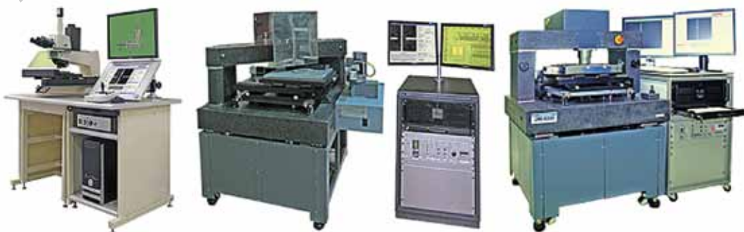
Рис. 7. Контрольно-измерительное оборудование для контроля изделий микроэлектроники, оснащенное системами автоматической фокусировки
