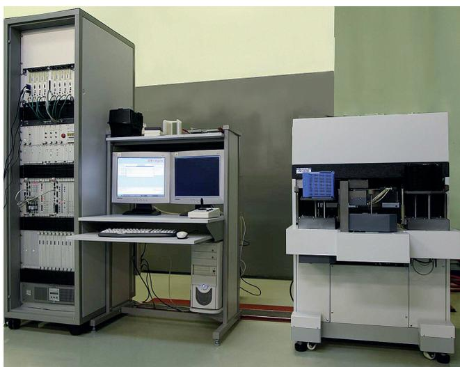
**Рис.10.** Установка контроля микродефектности ЭМ-6429
