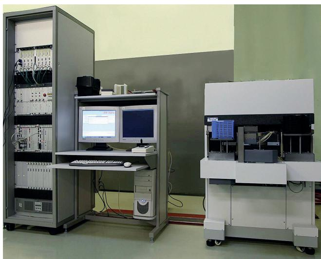
**Рис.10.** Установка контроля микродефектности ЭМ-6429
