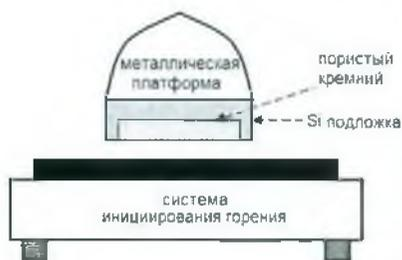
Рис. 1 – Схематическое изображение экспериментальной установки
