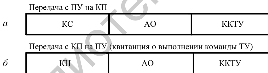
a – структура команды ТУ; б – квитанция о выполнении команды ТУ Рисунок 4.7 – Структура сигналов в режиме передачи команд ТУ в системе ТУ – ТС с одним КП
