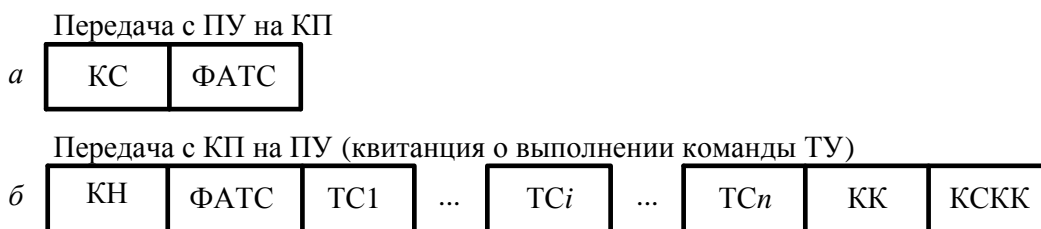
a – структура сигнала вызова ТС; б – структура сообщений ТС Рисунок 4.6 – Структура сигналов в режиме циклического вызова ТС в системе ТУ – ТС с одним КП
