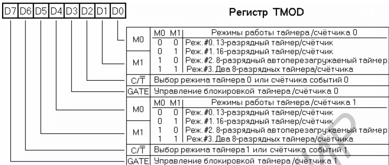
Рис. 22. Регистр режима таймеров/счётчиков TMOD
