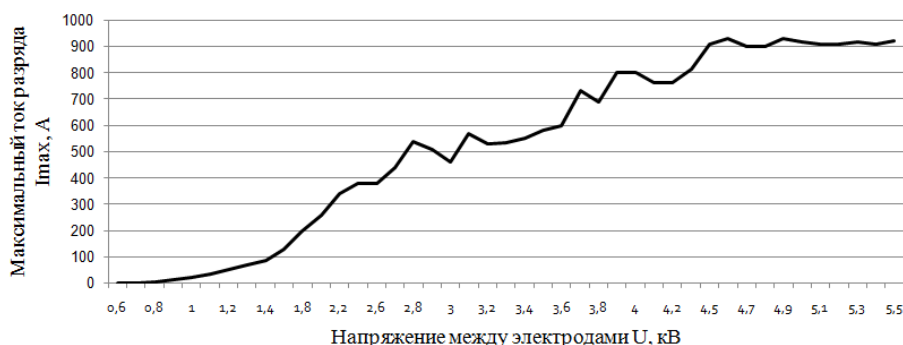
Рисунок 2 – Зависимость максимально достигаемого тока разряда от приложенного напряжения
