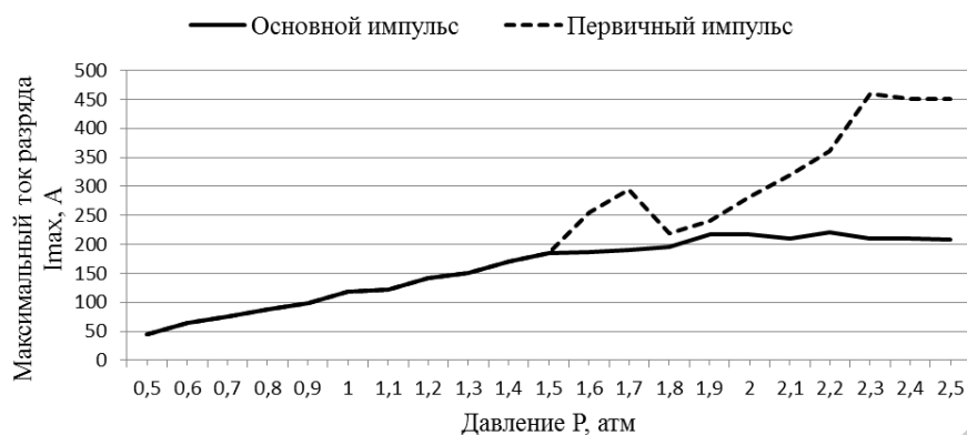
Рисунок 5 – Зависимость максимального тока разряда от давления газа
