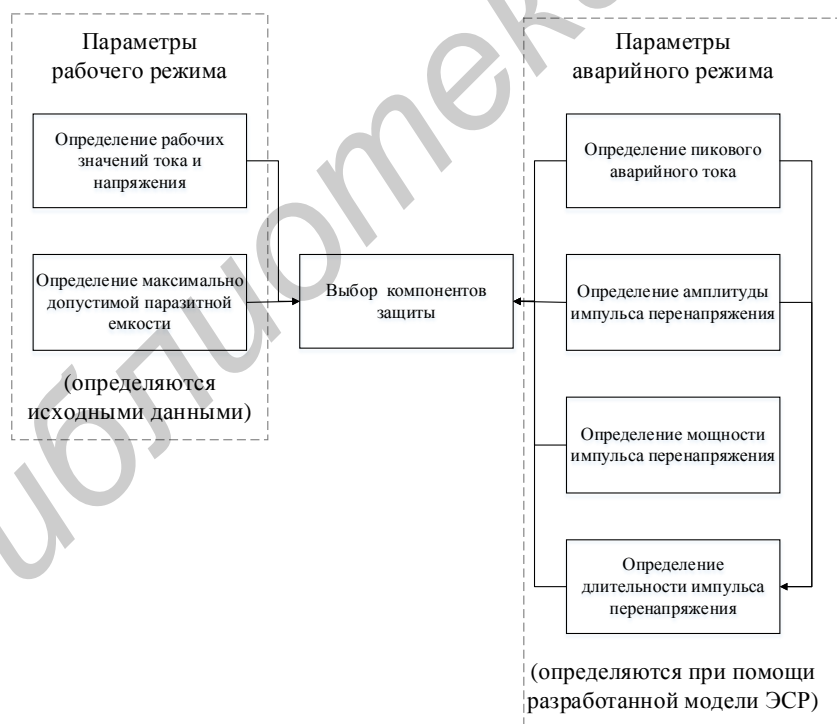
Рисунок 9– Методика выбора компонентов схемы защиты
