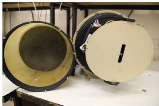
Рис. 12. Двухзеркальная сканирующая антенна с плоским контррефлектором
