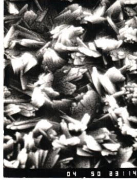
Рис. 2. Поверхность пленки теллура, осажденной на алюминиевую подложку при скорости осаждения V = 8,0 нм/с и толщине, d = 150 нм ( \times 50\,000 )
