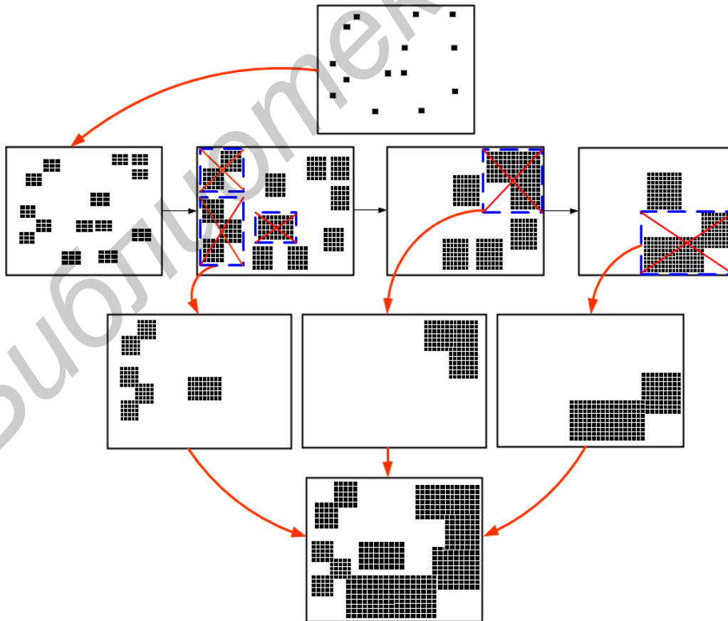
Рис. 1. Объединение равноудаленных центральных точек контурных элементов
