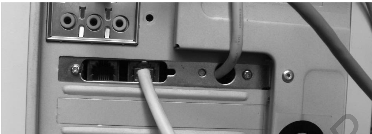
Рисунок 1.21 – Адаптер RS-485 на задней панели ПЭВМ
