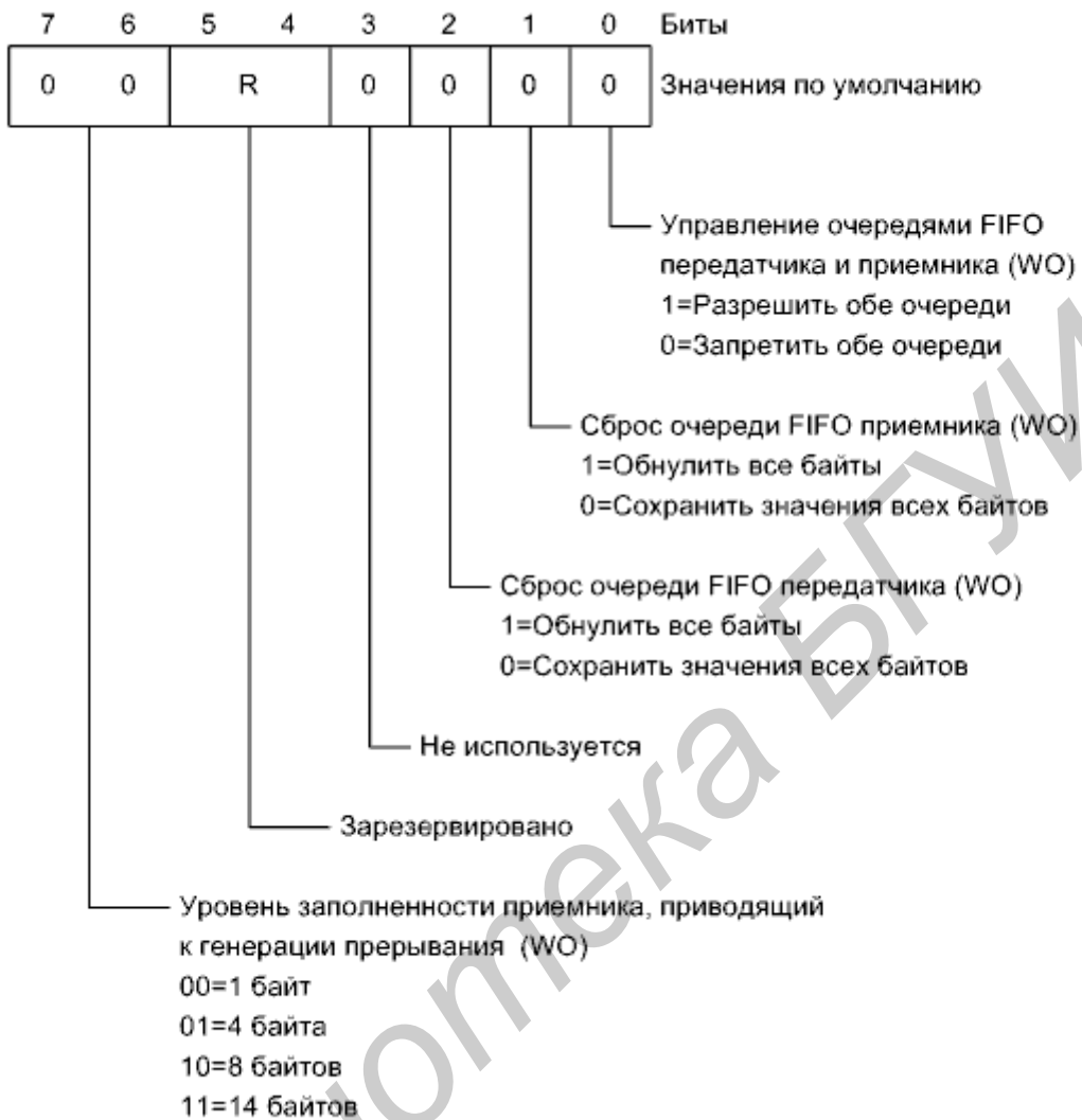
Рисунок 1.15 – Регистр управления очередями FIFO передатчика и приемника
