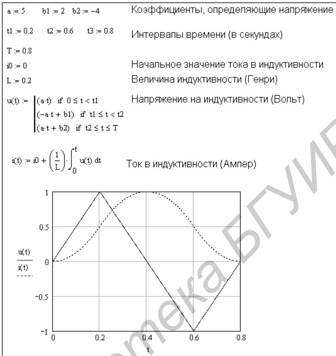
Рис. 2.13. Построение графиков мгновенных значений напряжения и тока в индуктивности
