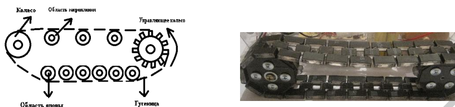
Рис. 1 - Структурная схема гусеничного движителя Рис. 2– Подложка гусеничного движителя
