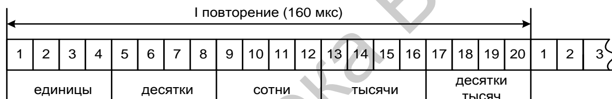
Рис. 5.3. Структура информационной части в IV режиме
