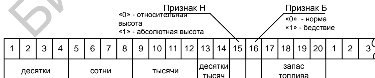
Рис. 5.4. Структура информационной части в VI режиме
