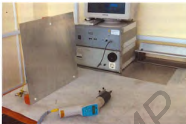
Рисунок 1 – Внешний вид установки для проведения испытаний МТ на устойчивость к воздействию разрядов статического электричества
