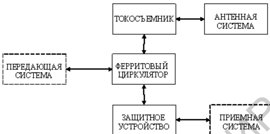
Рис. 1.6. Общая функциональная схема РЛС
