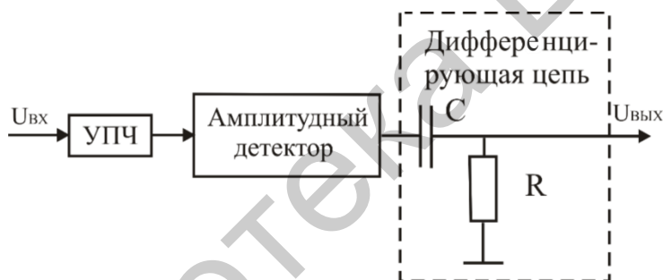
Рис. 2.13. Дифференцирующая цепь в видеотракте приемника
