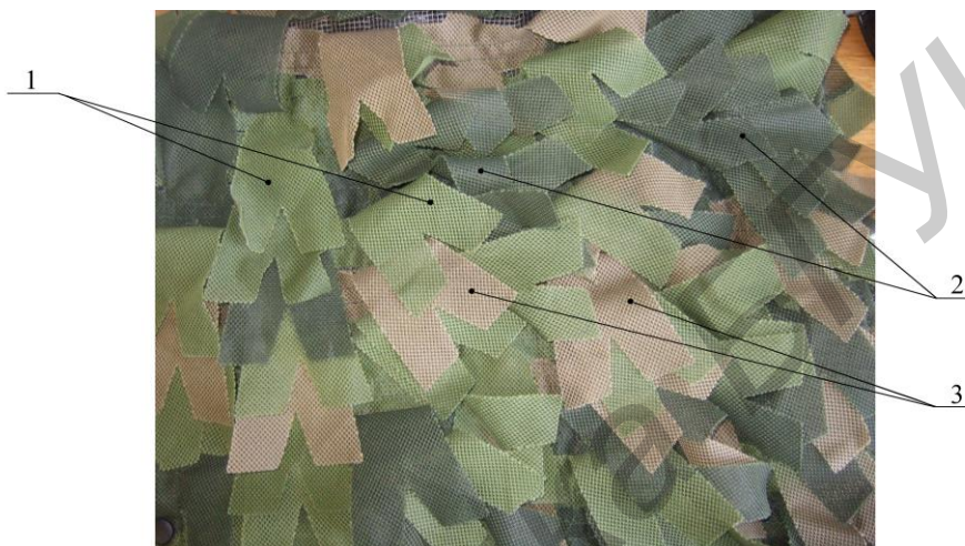
Рис. 1. Объект исследования – комбинированный сетчатый материал, состоящий из лепестков различной окраски: 1 – светло-зеленые; 2 – темно-зеленые; 3 – светло-коричневые
