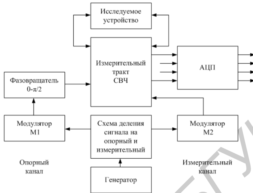
Рис. 2. Структурная схема СВЧ тракта, используемого для получения квадратурных сигналов в ВАЦ 75–110 ГГц
