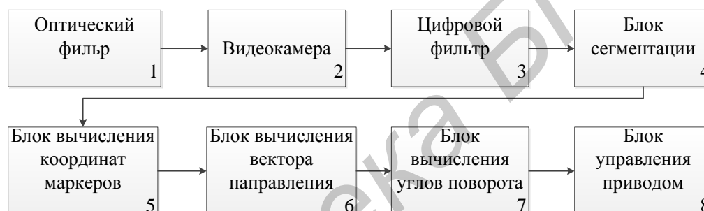
Рис. 2. Структурная схема управления поворотной камерой
