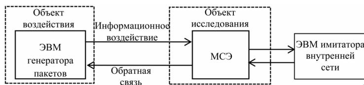
Рис. 3. Схема полунатурной модели ИТС
