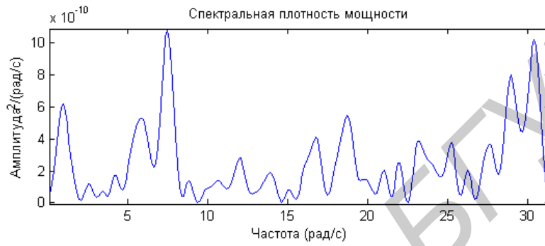
Рис. 4. Выход генератора шума W (узел 1)
