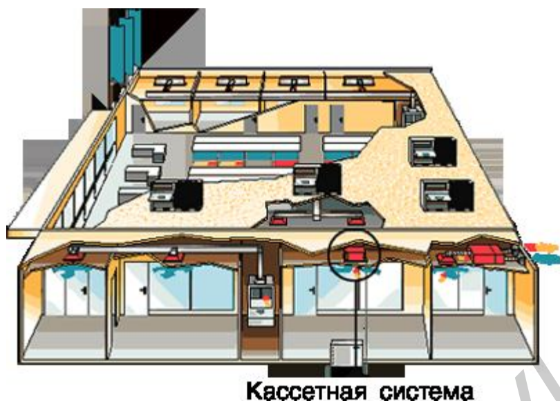
Рис. 2.6. Схема размещения сплит-системы кассетного типа
