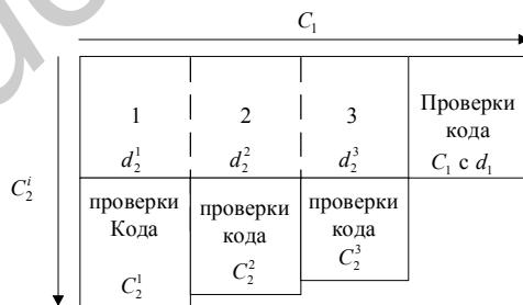
Рис. 3. Двумерное неравномерное кодирование с одним кодом для защиты всех зон
