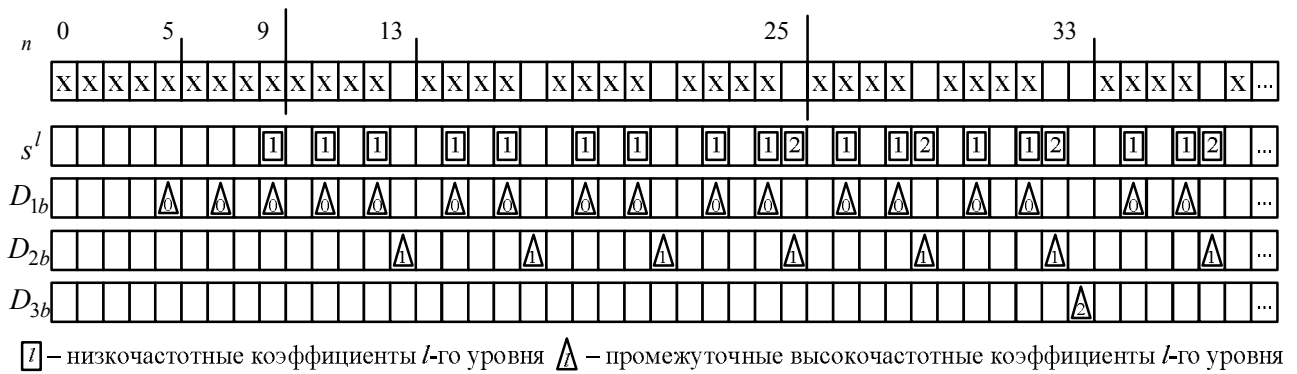
Рис. 2.19. Входные параметры элементов задержки D_{1b} , D_{2b} и D_{3b} рекурсивной вейвлет-архитектуры и появление низкочастотных вейвлет-коэффициентов s^l
