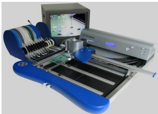
Рисунок 4.9 – Автоматы установки SMD: pick&place (а) и турельного типа (б)
