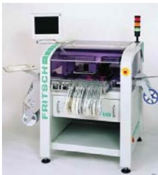
Рисунок 4.10 – Автомат установки компонентов Place ALL600
