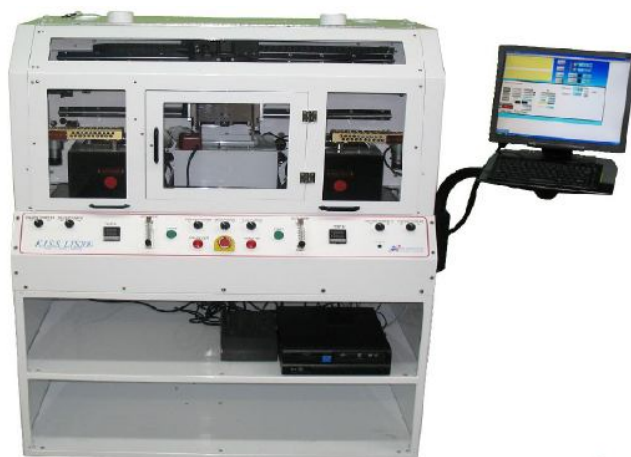
Рисунок 4.3 – Автомат лужения выводов в азотной среде KISS-LTS-200
