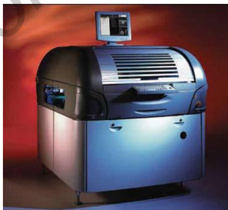
Рисунок 4.8 – Автомат трафаретной печати HORIZON
