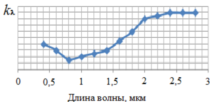
Рис. 5.8. Спектр поглощения типичной кровенаполненной биологической ткани толщиной 1 мм в области длин волн 0,4–2,8 мкм
