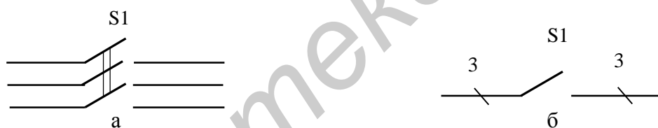
а – многолинейное изображение; б – однолинейное изображение Рисунок 9.2 – Фрагмент схемы электрической принципиальной
