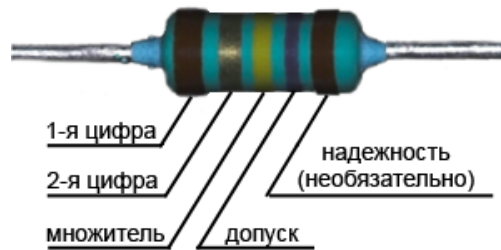
Рис. 1.4. Схема цветовой кодировки резисторов
