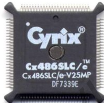
Рис. 5.4. Интегральная микросхема в QFP-корпусе (а) и BQFP-корпусе (б)
