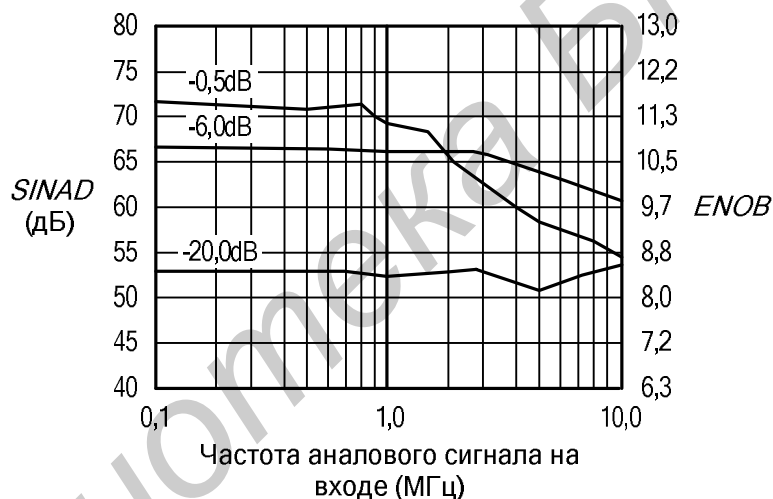
Рис. 5.4. Отношение сигнал/шум/искажения ( \text{SINAD} ) и эффективное число ( \text{ENOB} ) разрядов при различных уровнях входного сигнала
