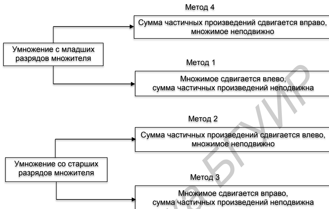
Рисунок 9 – Методы умножения двоичных беззнаковых чисел
