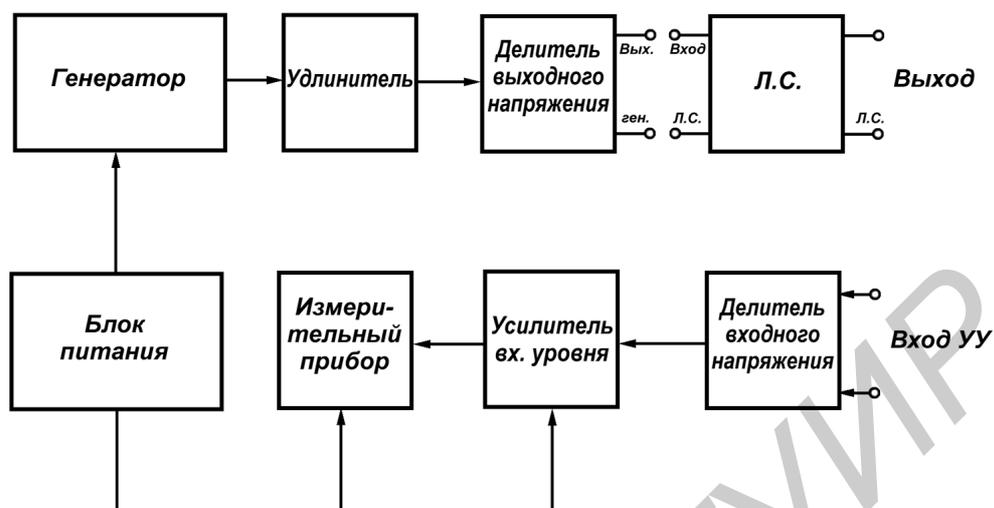
Рис. 3.1. Структурная схема прибора П-321
