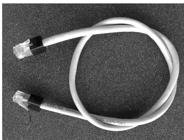
Рисунок 6.8 – Кабель TxRx-RxTx («накрест») для АГМ-32
