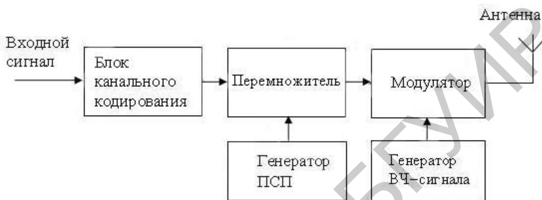
Рис. 1.3. Структурная схема передающего тракта системы с кодовым разделением каналов
