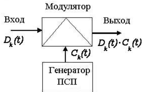
Рис. 1.1. Принцип получения сигналов с расширенным спектром
