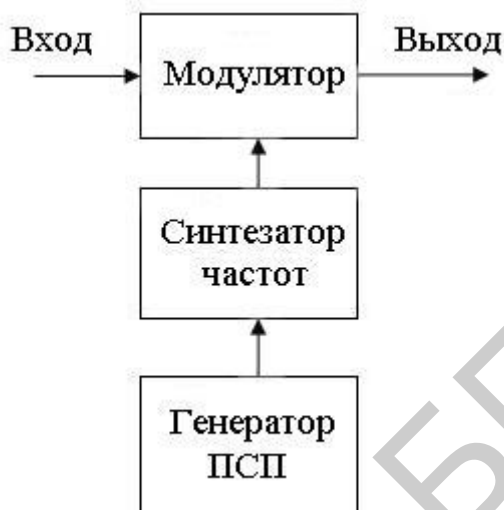
Рис. 1.4. Принцип получения сигналов с расширенным спектром при использовании скачкообразной перестройки частоты
