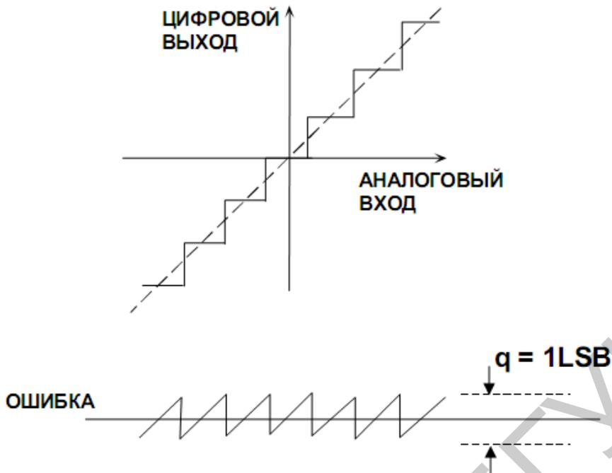
Рисунок 5.4 – Шум квантования идеального  $N$ -разрядного АЦП
