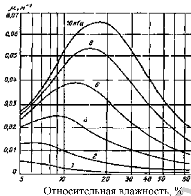
Рисунок 3.5 – Зависимости коэффициента затухания звука в воздухе от относительной влажности и частоты (по данным Э. Ивенса и Э. Безли)
