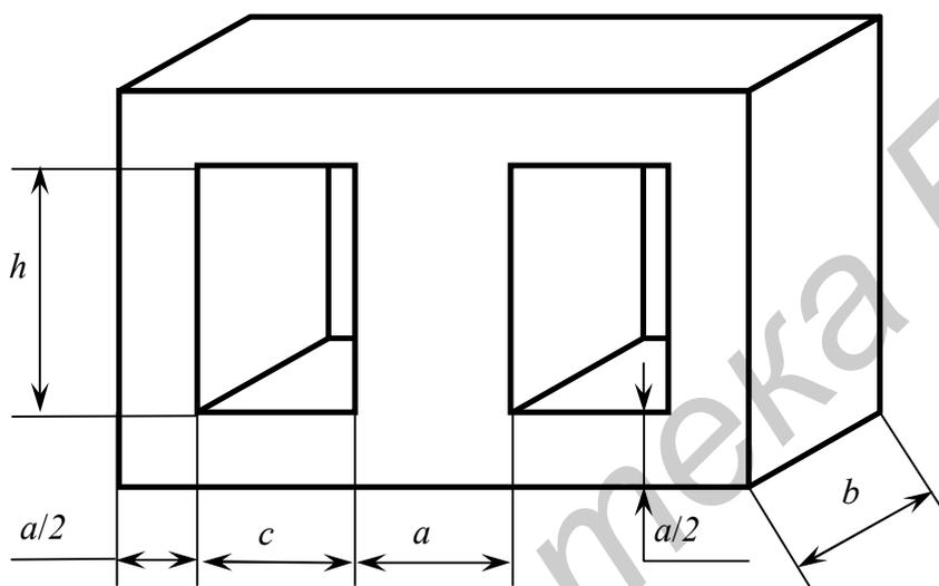
Рис. 12.1. Магнитопровод броневого трансформатора
