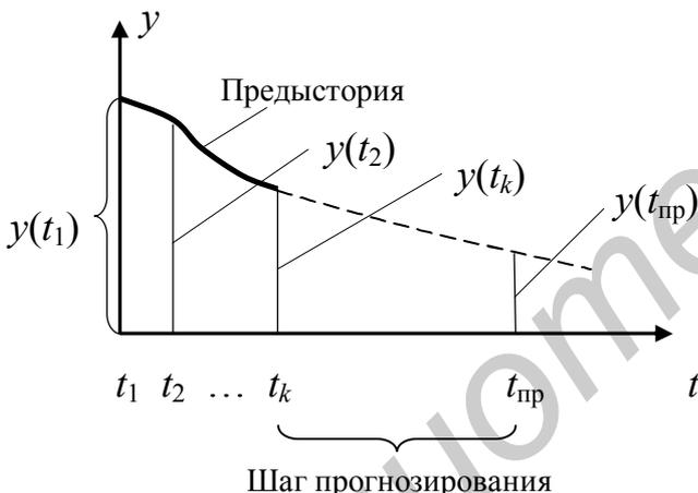
**Рис. 6.2. К вопросу о прогнозировании методом экстраполяции**
