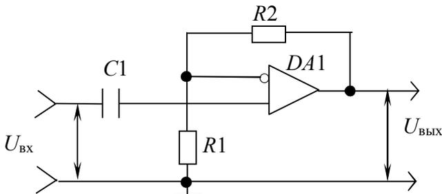
Рис. 3.2. Электрическая принципиальная схема усилителя
