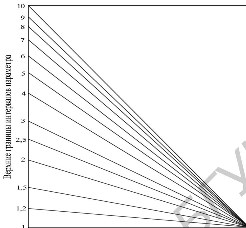
**Рис. 8.2. Шаблон для построения шкалы параметра вероятностной бумаги логарифмически нормального распределения и распределения Вейбулла**
