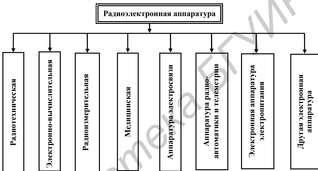
Рис. 1.8. Классификация РЭА по функциональному назначению и принципу действия
