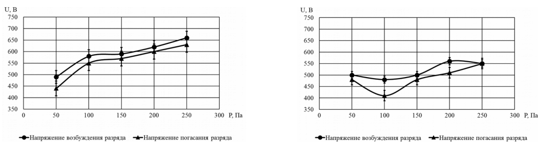
Рис.4 - Напряжения возбуждения и погасания разряда с ЭПК в N_2 а) для вставки с полым выступом б) для вставки с кольцевыми проточками в донной части
