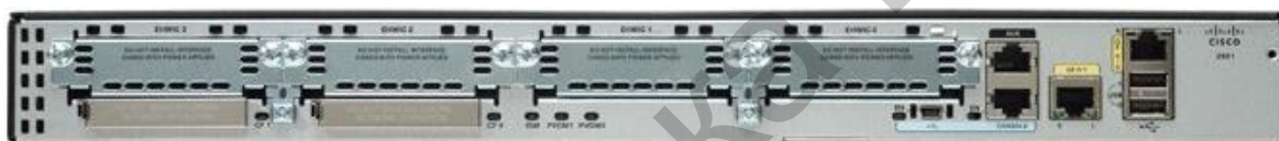
Рисунок Б.4 – Передняя панель маршрутизатора Cisco 2901 ISR
