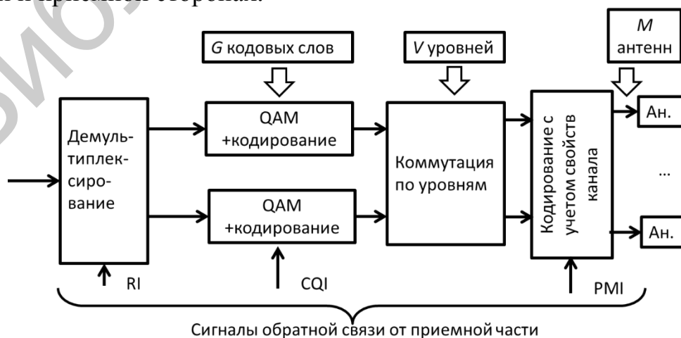
Рис. 4.1. Схема SU-MIMO на передающей стороне
