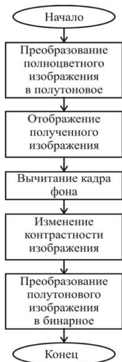
Рис. 1. Алгоритм предварительной цветовой обработки видеок кадров
