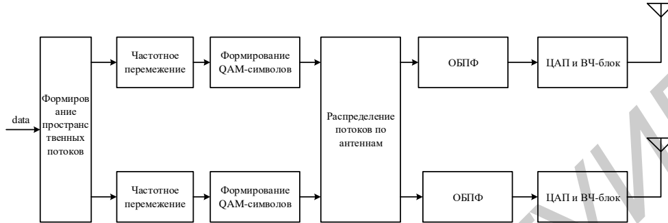
Рис. 4. Схема передатчика OFDM с использованием MIMO
