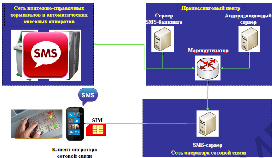
Рис. 3.3. Схема функционирования SMS-банкинга
