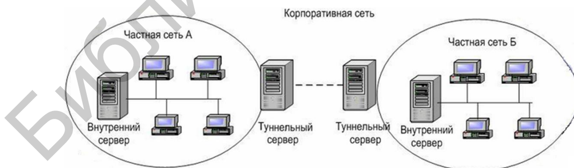
Рис. 5.7. Схема реализации внутрикорпоративной сети VPN
