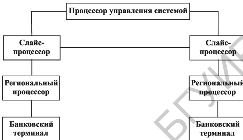
Рис. 2.7. Архитектура системы SWIFT II
