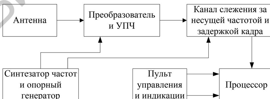
Рис. 13.3. Структурная схема аппаратуры потребителей третьего класса
