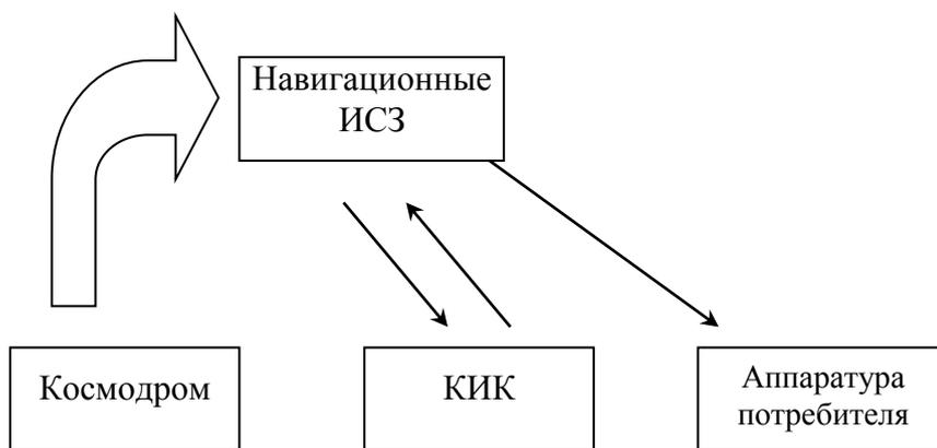
Рис. 10.1. Упрощенная структура спутниковой РНС
