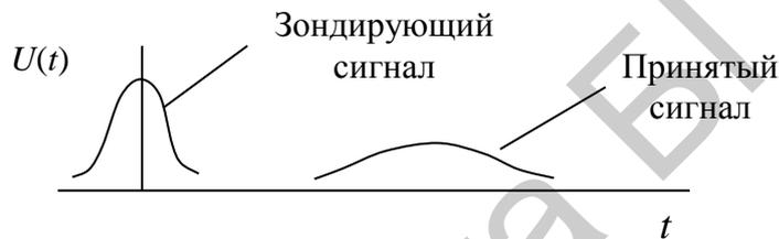
Рис. 2.4. Искажение закона модуляции из-за дисперсии радиоволн
