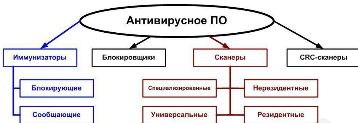
Рис. 36. Классификация антивирусного программного обеспечения
