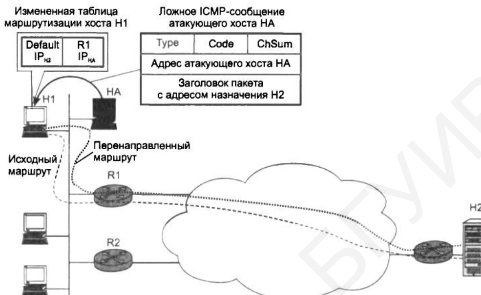
Рис. 34. Пример использования злоумышленником протокола ICMP
