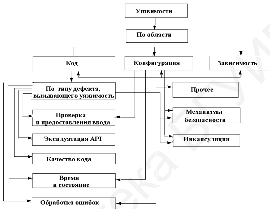
Рис. 4 Классификация уязвимостей по области их определения
