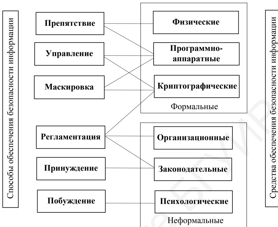
Рис. 8. Способы и средства обеспечения безопасности информации
