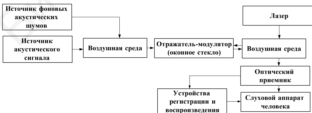
Рис. 19. Структурная схема оптико-акустического канала
